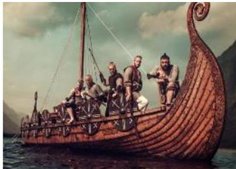
La técnica empleada para la construcción de las naves vikingas es en tingladio. El casco de estas naves estaba construido sobre una sólida quilla que, junto con la roda
